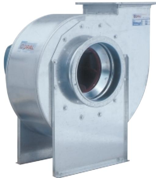
**CAMPO D'IMPIEGO:** gli elettroventilatori centrifughi serie "PR" a pale rovesce presentano un campo d'impiego con basse e medie prevalenze totali da 59 a 460 mm. H<sub>2</sub>O e portate da 1000 a 18600 m<sup>3</sup>/h con temperature massime dell'aria pari a 60°C.
