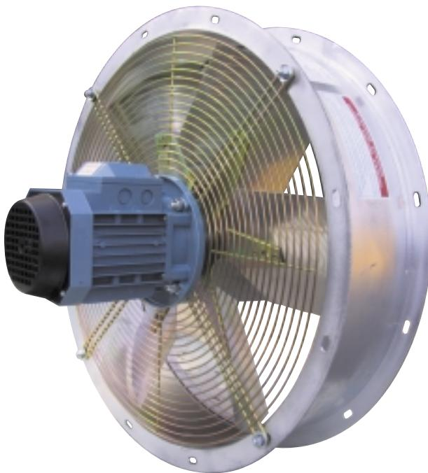
**CAMPO D'IMPIEGO:** gli elettroventilatori elicoidali serie EER a pale reversibili presentano un campo d'impiego con prevalenze statiche molto basse, da 1 a 20 mm H<sub>2</sub>O portata elevata da 1900 a 38000 mc/h con temperature massime dell'aria pari a 60°C;
