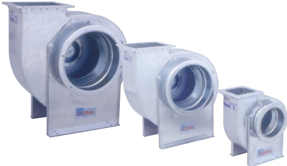
**CAMPO D'IMPIEGO:** gli elettroventilatori serie "AC" a multipale presentano un campo d'impiego con prevalenze totali relativamente basse, da 15 a 110 mm. H<sub>2</sub>O e portate elevate, da 700 a 16000 mc/h, con temperature massime dell'aria pari a 60°C.
