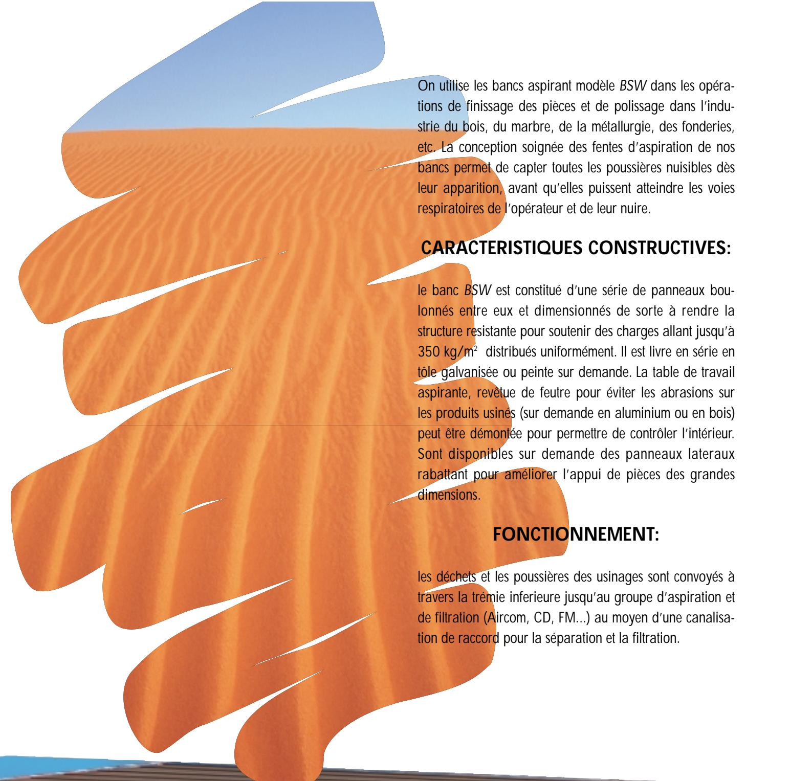
On utilise les bancs aspirant modèle *BSW* dans les opérations de finissage des pièces et de polissage dans l'industrie du bois, du marbre, de la métallurgie, des fonderies, etc. La conception soignée des fentes d'aspiration de nos bancs permet de capturer toutes les poussières nuisibles dès leur apparition, avant qu'elles puissent atteindre les voies respiratoires de l'opérateur et de leur nuire.
