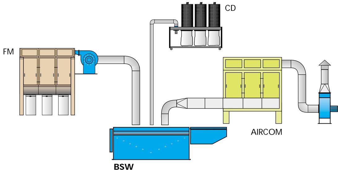
Die Absaugvorrichtungen Modell *BSW* werden im Bereich der Feinbearbeitung von Werkstücken und beim Honen in der Holz-, Marmor-, Metallindustrie und in Gießereien verwendet. Der gewissenhafte Entwurf der Absaugschlitze unserer Vorrichtungen ermöglicht die vollständige Absaugung des entstehenden schädlichen Staubs, bevor dieser die Atemwege des Bedieners erreicht und schädigen kann.
